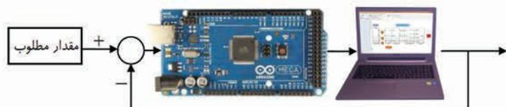
در این آزمایش، دانشجویان با استفاده از شبیه‌سازی سخت‌افزار در حلقه می‌توانند عملکرد سخت‌افزار کنترل کننده را اعتبارسنجی کنند. در این روش فرامین کنترلی با استفاده از ابزار تولید خودکار کد بر سخت‌افزار کنترل کننده پیاده‌سازی شده و به مدل سه‌درجه آزادی نرم‌افزاری چهارپره اعمال می‌شود. از این‌رو، به منظور اعتبارسنجی حلقه‌های کنترل کننده دانشجویان بهره‌های کنترل کننده را طوری تنظیم می‌کنند که نتایج آن با نتایج شبیه‌سازی نرم‌افزاری یکسان شود.
