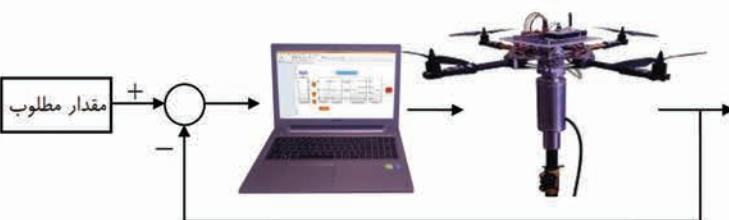
در این آزمایش، دانشجویان با استفاده از مکانیزم سه‌درجه آزادی می‌توانند عملکرد حلقه‌های کنترلی رول، پیچ و یا و را اعتبارسنجی کنند. در این صورت، مدل کنترل کننده به صورت نرم‌افزاری است که با استفاده از ابزار زمان واقعی RTWT به مکانیزم سه‌درجه آزادی چهارپره اعمال می‌شود. در این صورت، می‌توانند اثر ترم‌های تناسبی، انتگرالی و مشتقی را بر عملکرد سیستم حلقه‌بسته و همچنین مقاوم‌بودن سیستم حلقه بسته به خطای مدل سازی و اغتشاش را بررسی کنند.
