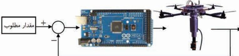
در این آزمایش، دانشجویان با استفاده از مکانیزم سه‌درجه آزادی می‌توانند نحوه کنترل همزمان زوایای رول، پیچ و یا و یک چهارپره را تجربه کنند. در این مکانیزم بین کانال‌های رول، پیچ با کanal یا و کوپلینگ وجود دارد. از این‌رو، دانشجویان برای پنهانی باند هر یک از حلقه‌های کنترلی از کنترل کننده PID را طوری تنظیم کنند که تداخل کاری نیز بین کانال‌ها پیش نیاید.
